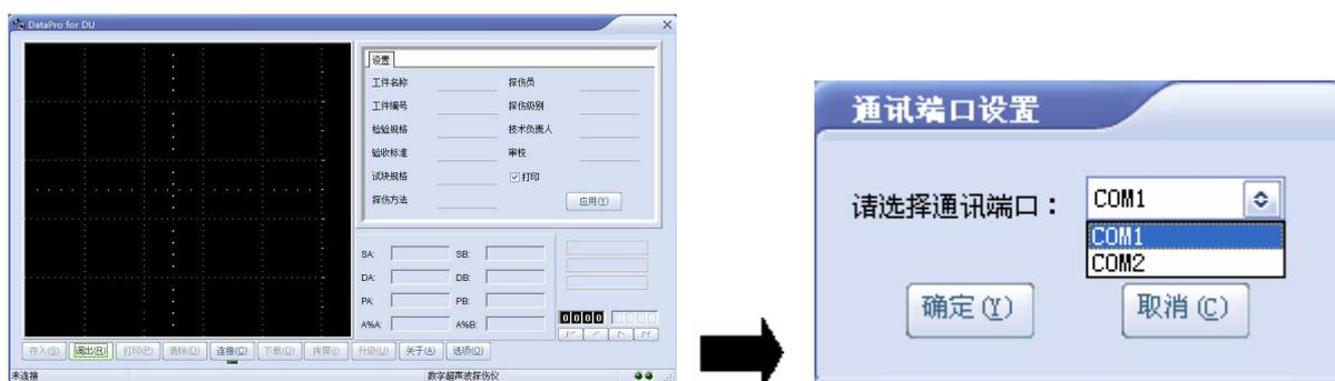
第二步：选择计算机上与探伤仪连接的通讯端口（COM），点 **确定(Y)** 按钮，软件自动与探伤仪进行连接测试。如果软件状态栏出现提示“通讯端口无效”，说明端口选择错误，请重新选择并连接探伤仪。
